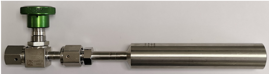
Cylindre simple vanne pour prélèvement de boîte à gants
